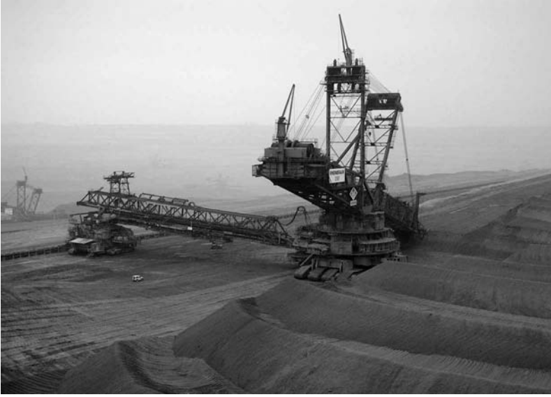
Hambach. Der Bagger räumt im Tagebauvorfeld das Deckgebirge, um schrittweise an die Braunkohle zu gelangen. © R. Jansen
