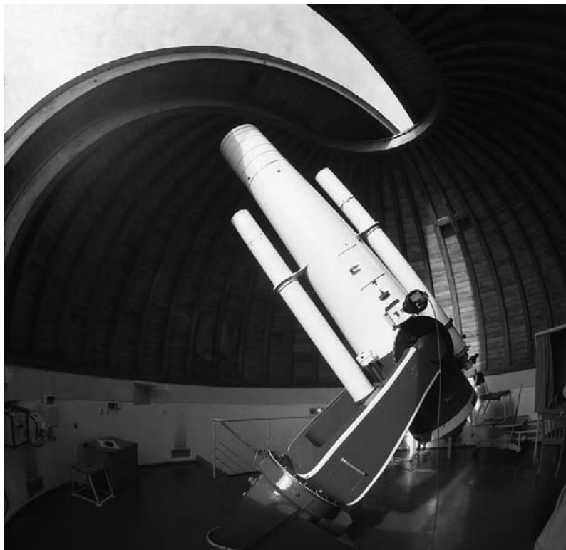
Daun. Der Schmidt-Spiegel mit einem Durchmesser des Spiegels von 50 cm. Er war das erste größere Teleskop, das 1953 auf dem Hohen List aufgestellt wurde. © Obs. Hoher List
