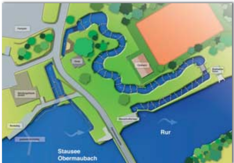
Obermaubach. Schematische Darstellung der Fischaufstiegs- und Abstiegsanlage
