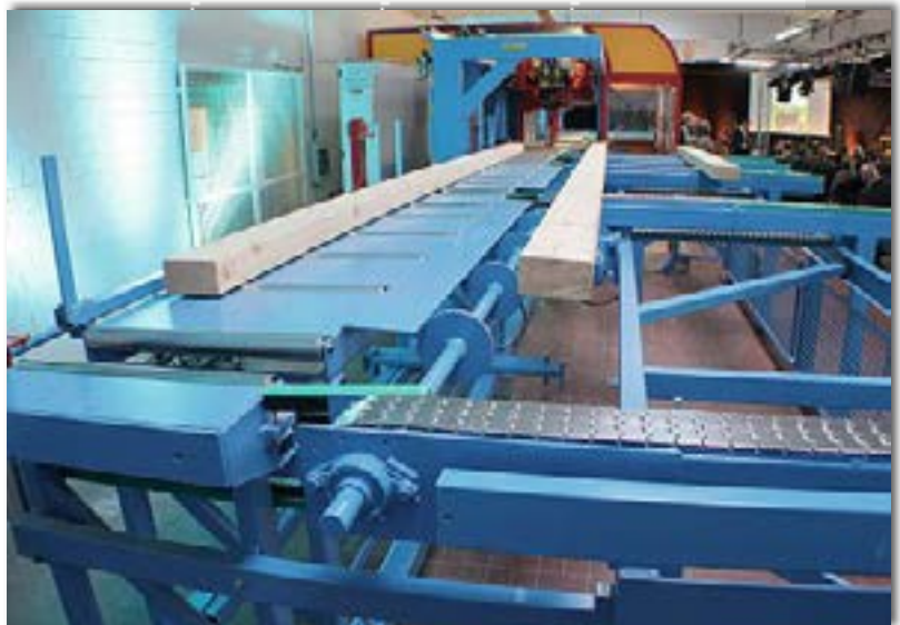
Die Abbundanlage Foto: Bernd Zimmermann
